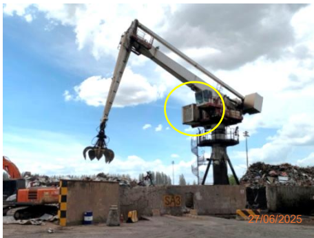
ภาพที่ 2.2-3 ห้องควบคุม Overhead Crane
