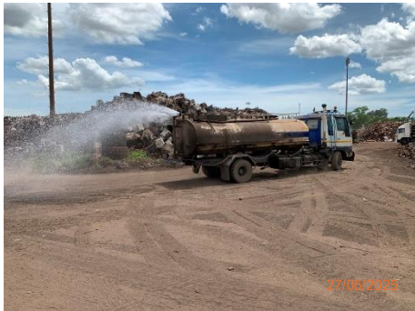
ภาพที่ 2.2-11 การนำน้ำทิ้งที่ผ่านการบำบัดแล้ว ไปใช้ประโยชน์ในการฉีดพรมถนนภายในโรงงาน
